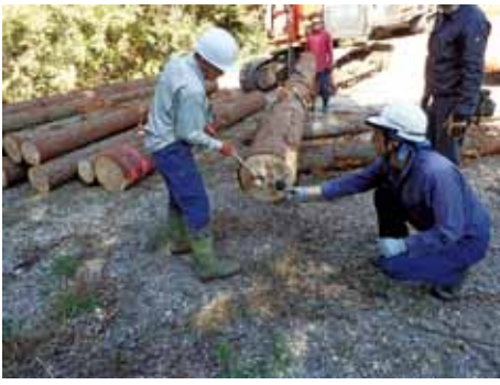
写真7 コウヨウザン丸太のヤング率の測定
