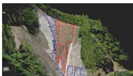
図2 3次元測量による面積計測
