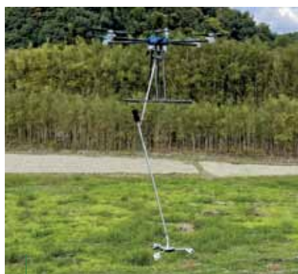
傾斜地に対応した下刈りドローンの開発
