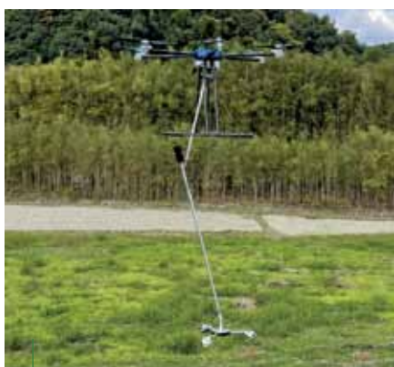
傾斜地に対応した下刈りドローンの開発
