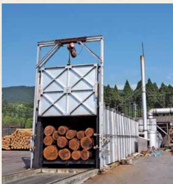
大径丸太の熱処理施設
