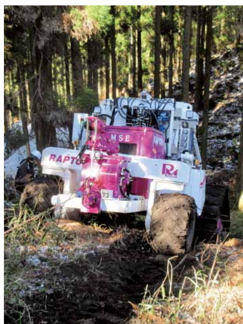
写真2 ワイヤーで傾斜地の走行を補助
