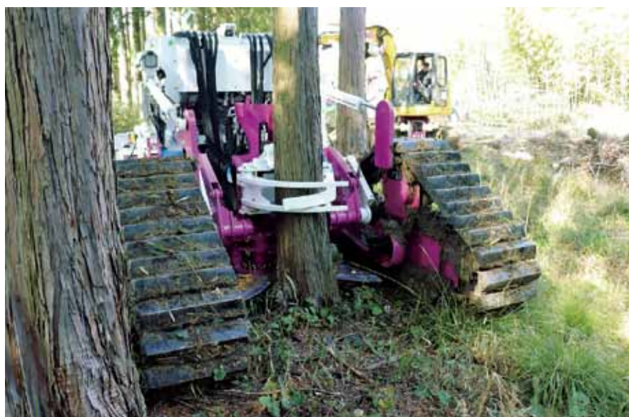
写真1 中央のアタッチメントで立木を掴みそのまま伐倒
