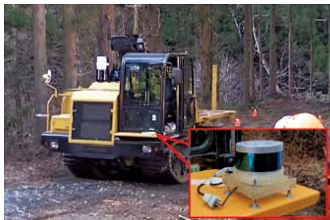
写真5 遠隔操作走行と3D-LiDERによる路面のスキニング
