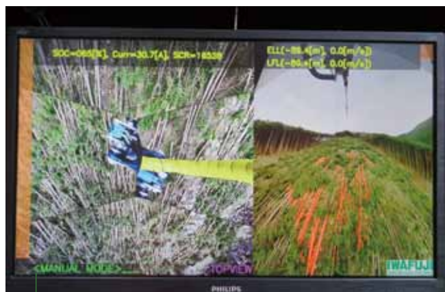
写真4 架線式グラップルに設置したカメラ映像
