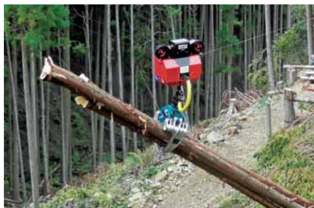
写真3 架線式グラップルによる集材作業
