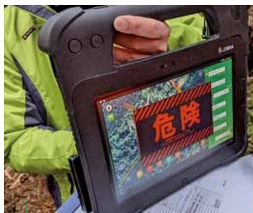
写真 10 通信アプリケーション画面(近接作業警告アラート表示)
