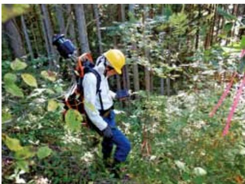
写真1 地上レーザー(TLS)による計測風景
