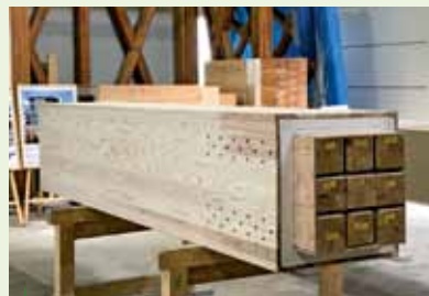
木造7階建てビルに使われているスギ製材の「束ね柱」
