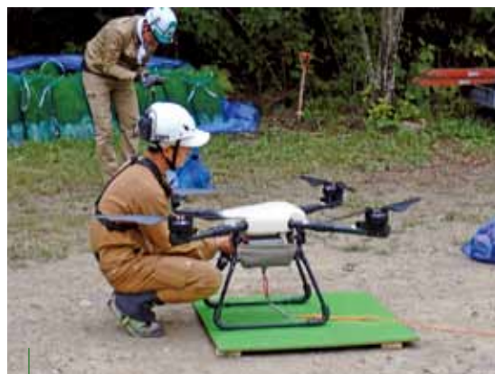
苗木等の重量物の運搬が可能な大型ドローン
