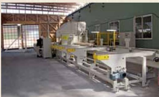
写真3 大断面プレカット加工機
