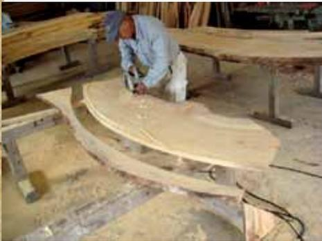
鷹取勝巳氏による丸鋸での輪板切断作業
