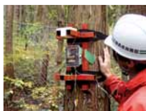
自動捕獲及び通報装置
