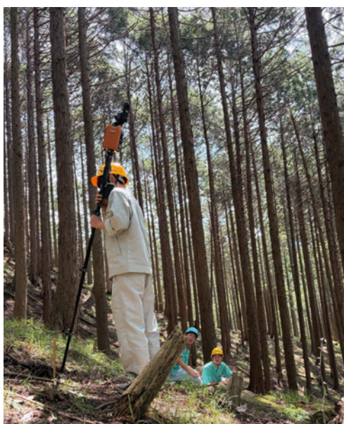
森林3次元計測システムOWLで計測
