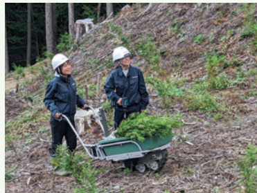
小型運搬車（電動クローラ型1輪車）
