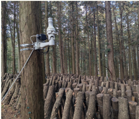
デジタル技術を活用した原木しいたけ栽培 (環境データを計測するセンサーを設置したほだ場)
