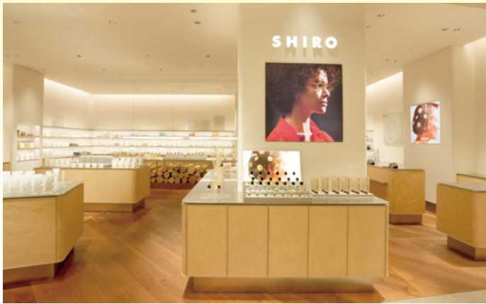
建築端材や廃材により内装の木質化した「SHIRO 札幌ステラプレイス店」
