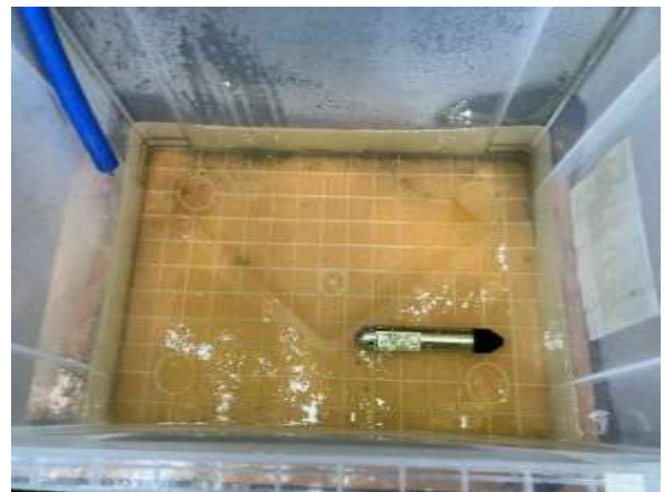
浸透水採水タンク・自記水位計
