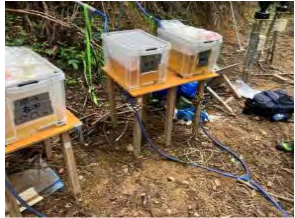
浸透水集水状況
