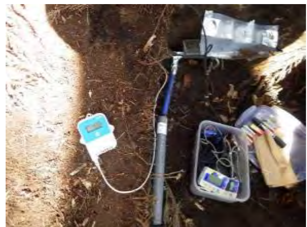
地温計設置状況
