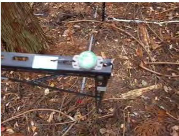
照度計設置状況近景
