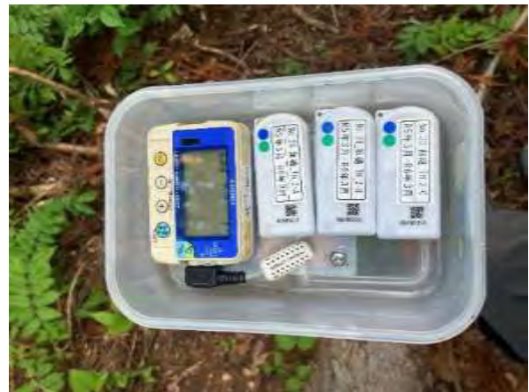
温湿度計設置状況
