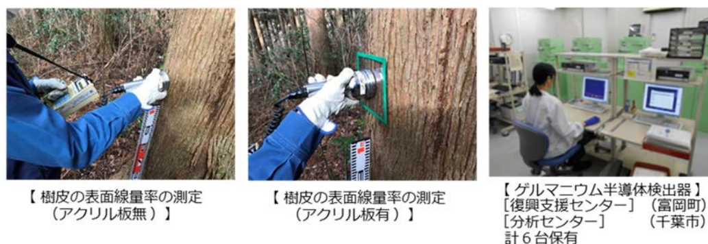
図 2.11 立木の樹皮の放射性セシウム濃度の測定イメージ
