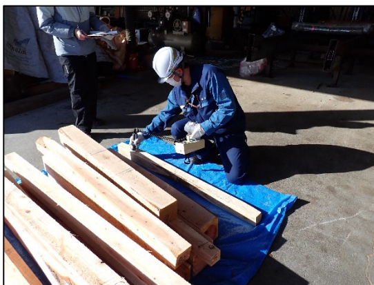
図 2.13 製材の表面線量測定状況
