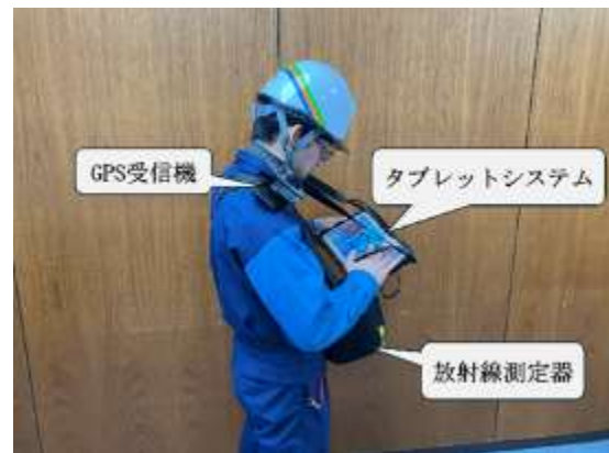
写真 4.2 放射線測定器外観及び測定状況
