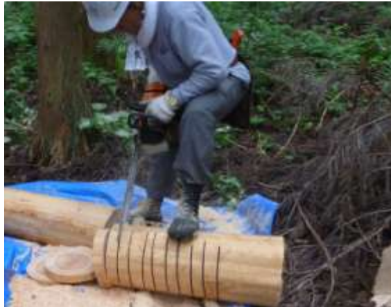
写真5 材の試料のサンプリング
