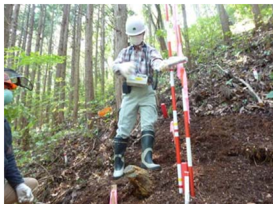
写真5 除去後の空間線量率の測定
