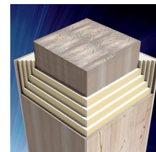
3時間耐火部材の開発した建築物 (2020年)
