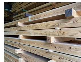
スギ横架材（120×240）のストック
