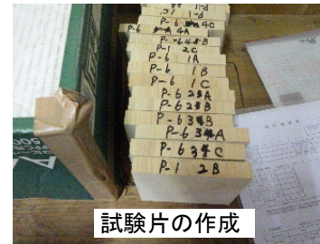
破壊検査 （全乾法）
