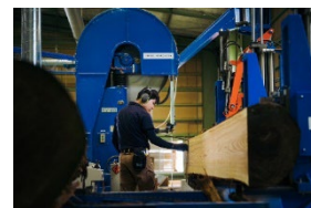
大径材用の加工機械の整備 (直径90cm対応)
