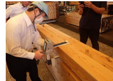
非破壊検査 （マイクロ波含水率計）
