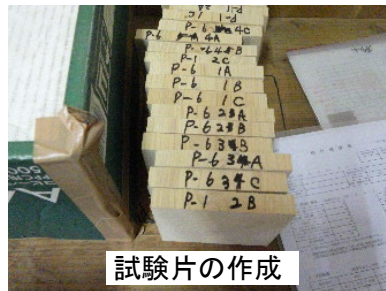
破壊検査 (全乾法)
