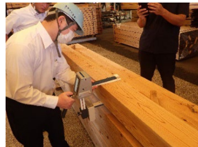
非破壊検査 (マイクロ波含水率計)
