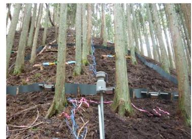
試験斜面枠と雨量計
