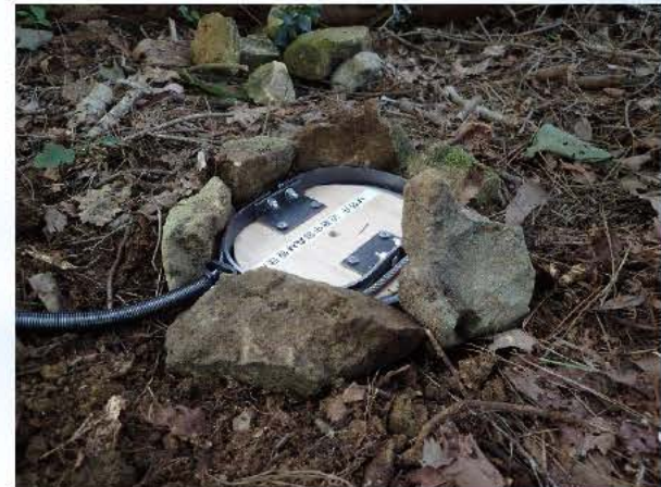
⑧ 塩ビ管の上に踏み板をセット
