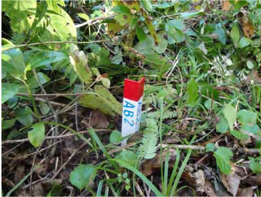
写真 I-3-2. 基点に設置した L 字杭
