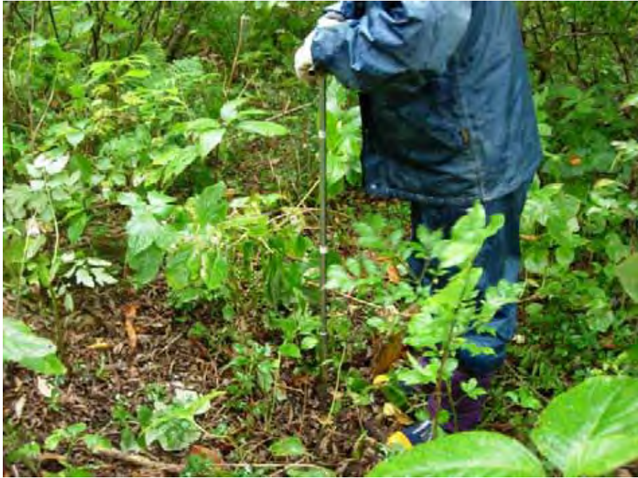
写真Ⅰ-3-3. 検土丈によるボーリングコアの採掘状況
