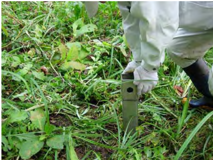
写真Ⅰ-3-5. ジオスライサーによるボーリングコアの採掘状況
