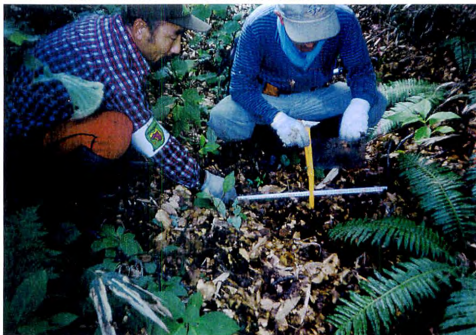
写真-132 踏み跡の断面形状測定
