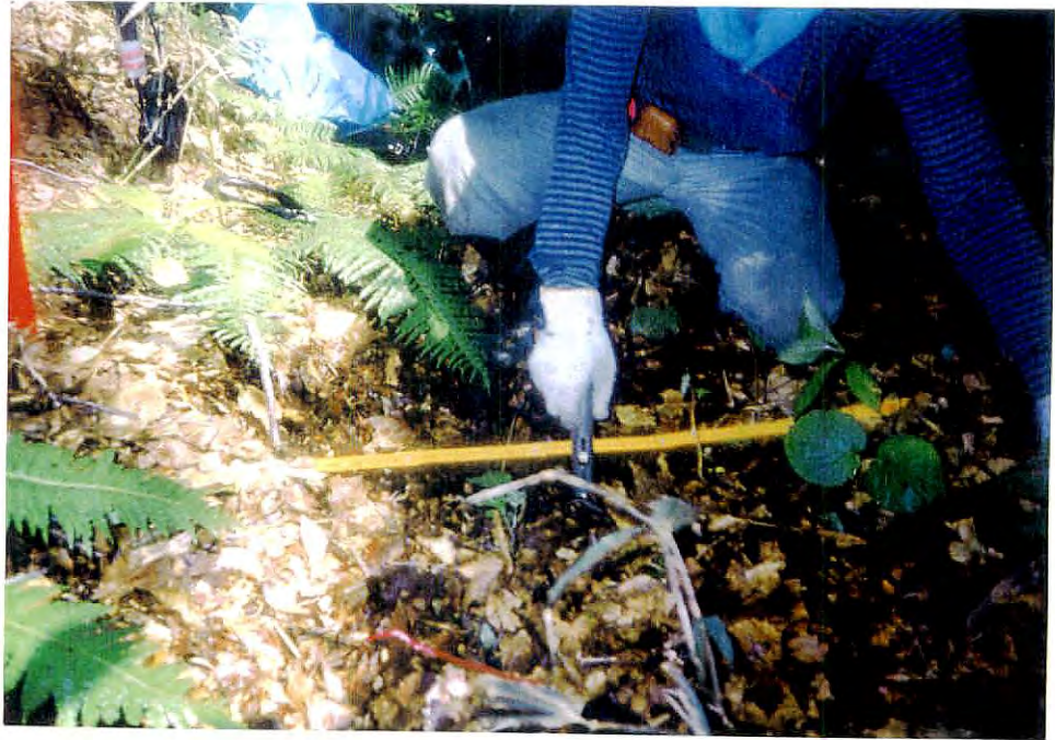
写真-133 踏み跡の土壌硬度測定
