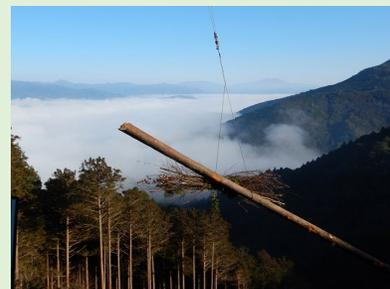
架線による素材と枝条の搬出
