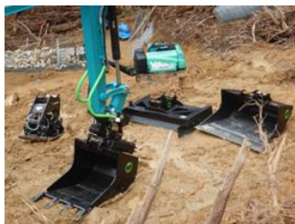
多彩ワークツールで、一連の施工が1機で可能
