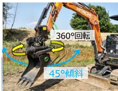
アタッチメントの傾斜(チルト)や回転(ローテーション)が可能
