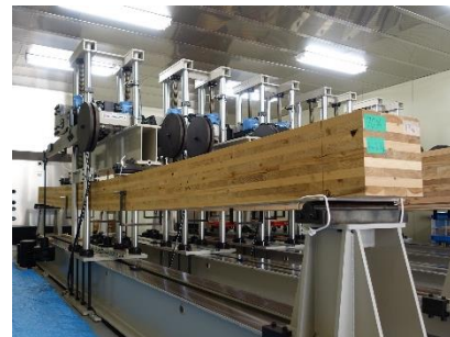
9層9プライCLTの長期的な強度性能の測定(2024年)
