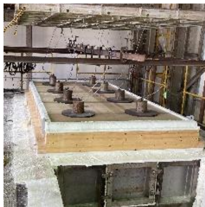
使用部位・用途拡大に向けた技術開発の取組み (耐火性能を検証するための試験の様子)
