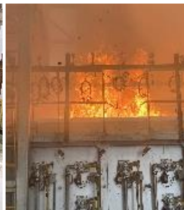
使用部位・用途拡大に向けた技術開発の取組み (耐火性能を検証するための試験の様子)
