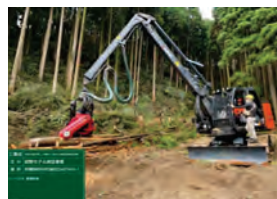
ロングリーチハーベスタによる造材、木寄せ
