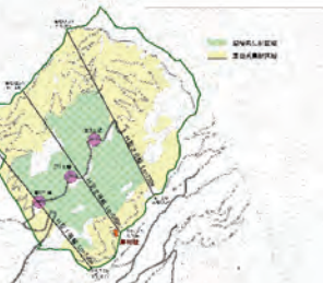
架線系(緑色)と車両系(黄色)を組み合わせた作業システム
