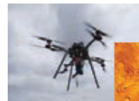
ドローンレーザによる崩壊危険箇所の特定
