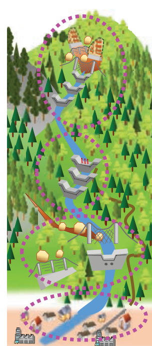
ワイヤーネットやスリットダムによる土石や流木の捕捉
