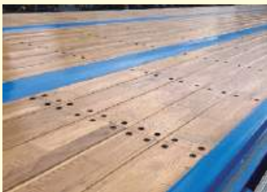
完成したコナラ材床板(左)とコナラ材床板を使用したトレーラ(右)
