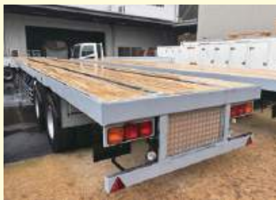
完成したコナラ材床板(左)とコナラ材床板を使用したトレーラ(右)
