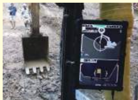
マシンガイダンス機能を搭載したバックホウのモニター
