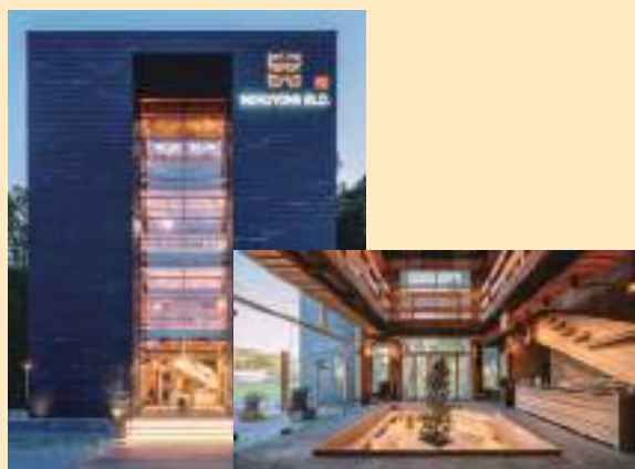
陸モクコンビル (長崎県壱岐市、令和5(2023)年1月竣工) 耐火構造にする必要のない立地条件から無垢製材の現しで実現した4階建て木造ビル
