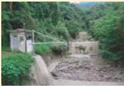
左：監視カメラと土石流センサーの設置 右上：カメラ映像 (桜島、鹿児島森林管理署)
