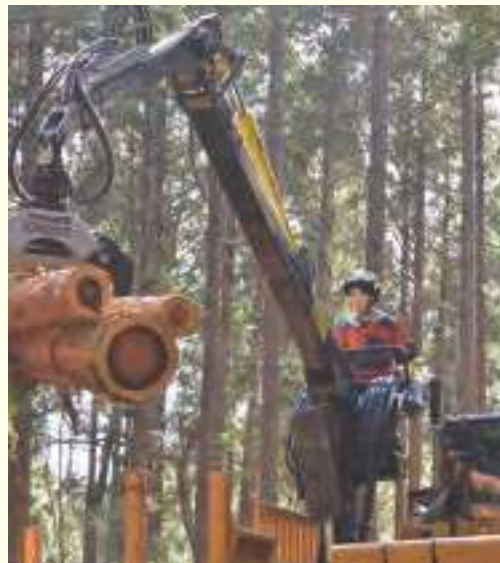
フォワーダによる集材作業
