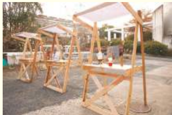
プロジェクトで開発した折り畳み式の屋台 (写真提供：株式会社地域計画建築研究所)
