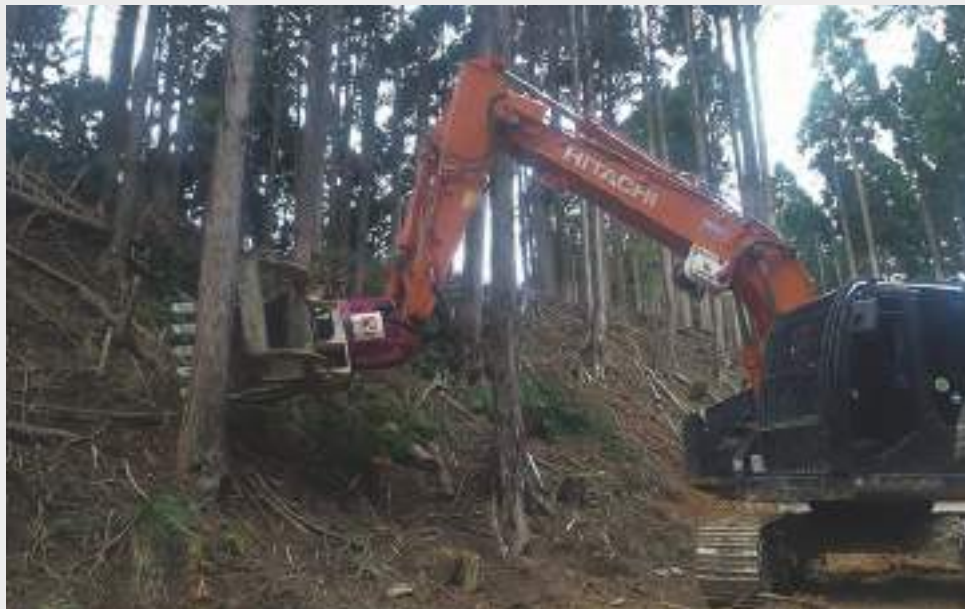
フェラーバンチャーによる立木伐採(岡山県西粟倉村)
