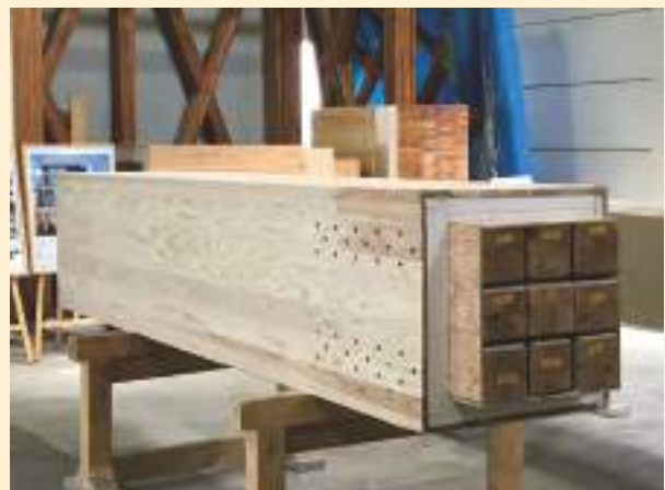
製材を束ねて石膏ボード等で被覆した木質耐火部材
