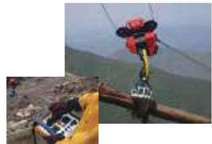
架線を走行するグラップルに搭載したカメラ映像を見ながら、集材作業を遠隔操作
