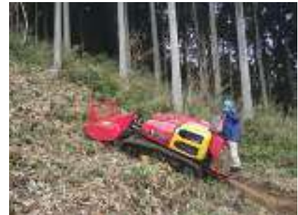
乗用型造林作業機による傾斜地での下刈り作業
