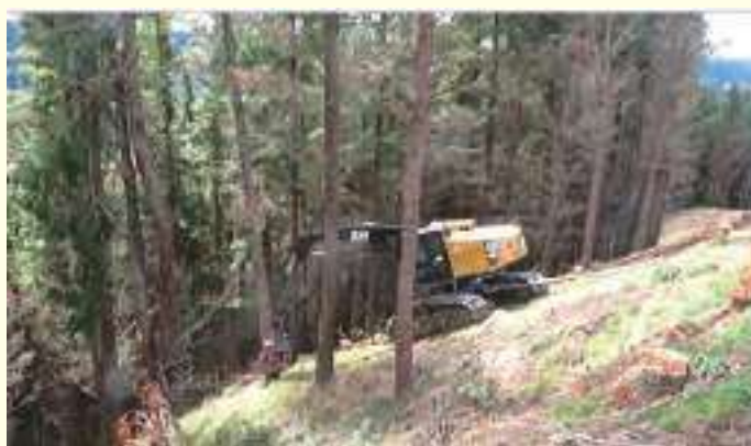
ウインチ付きエクスカベータ（油圧ショベル）にワイヤーで牽引され、急斜面で伐倒作業をするハーベスタ
