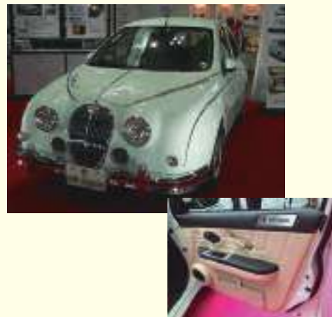
改質リグニンを用いた内外装部品をボンネット等に取り付けた実装車
