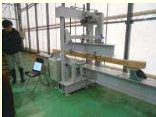
製材の曲げ強度を測定する静荷重試験機の導入
