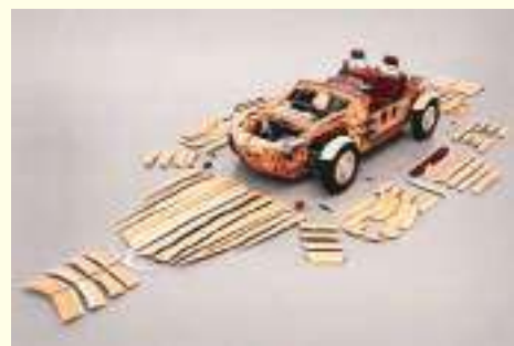
ボディは、86枚の木製パネルで構成され、交換が可能
