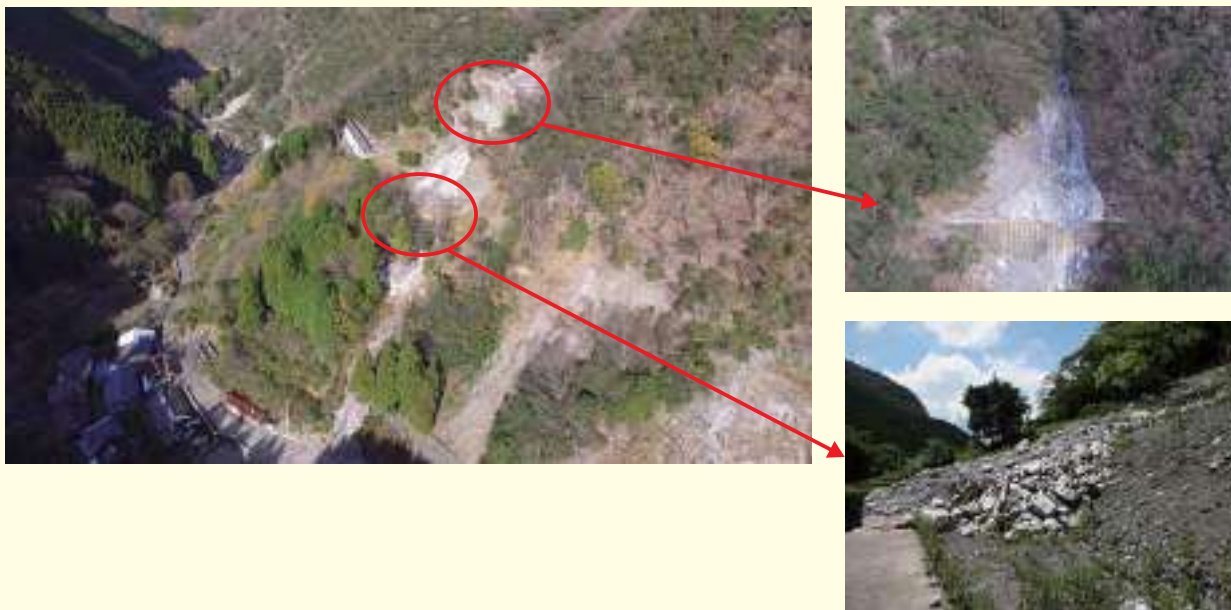
治山ダムによる土砂流出の抑制効果 (熊本県球磨郡五木村)
