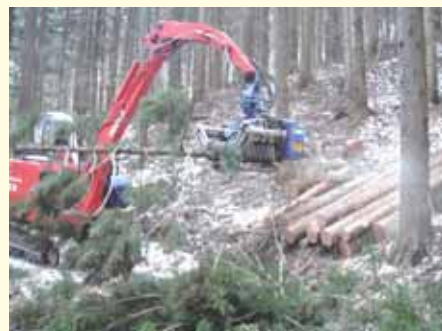
烏帽子国有林における間伐木の伐採・造材の様子
