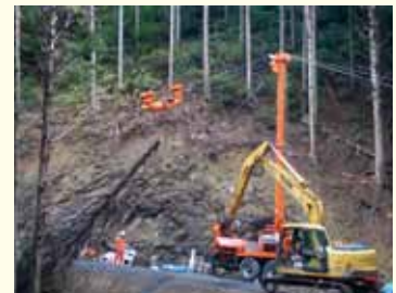
新たに導入したオーストリア製のタワーヤーダと搬器
