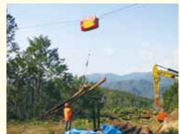
荷揚げ用ウインチを内蔵した高性能搬器
