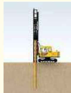
重機により保存処理木材を圧入
