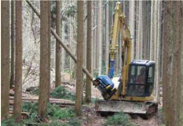
伐倒・枝払・玉切・集積を一貫して行う自走式機械
