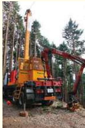
簡便に架線集材できる支柱を装備した集材機
