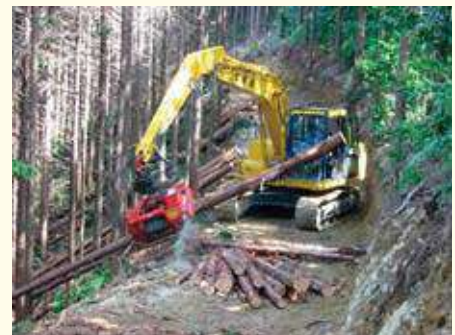
プロセッサによる造材
