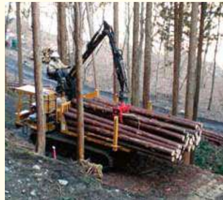
玉切した材をグラップルローダで荷台に積んで運ぶ自走式機械
