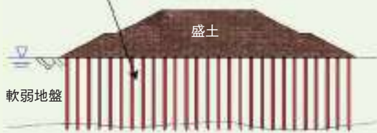
木材による軟弱地盤対策
