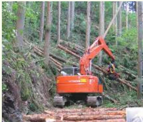
(写真はハーベスタによる伐倒・造材)
