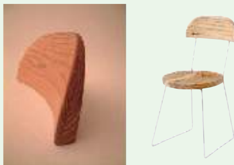
写真左：3次元圧縮されたスギ材、写真右：圧縮材を使用したダイニングチェア
