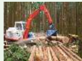
写真左：作業路の整備、写真右：プロセッサによる造材
