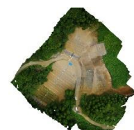
レーザスキャナを用いた3次元起工測量
