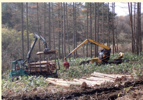
ICTハーベスタとフォワーダによるCTL作業システム
