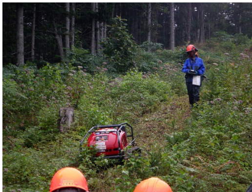
遠隔操作の機能を有する機械による下刈りの実演
