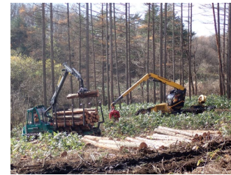
ICTハーベスタとフォワーダによるCTL作業システム
