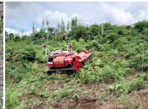
自動運転下刈り機械 (2027年頃実用化見込み) (千葉県君津市)
