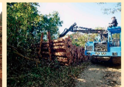
フォワーダによる丸太の運搬後、帰り荷でコンテナ苗を運搬
